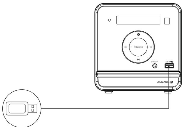
Le port USB permet également de recharger vos périphériques USB, en délivrant une tension de 5V --- 300mA, uniquement lorsque la micro-chaîne est allumée.
